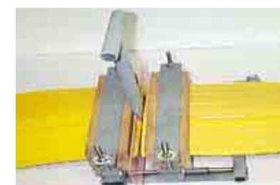
Zgrzewanie mieczem teflonowym
