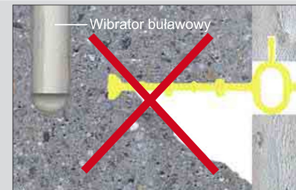
Nieprawidłowe zagęszczenie mieszanki betonowej
