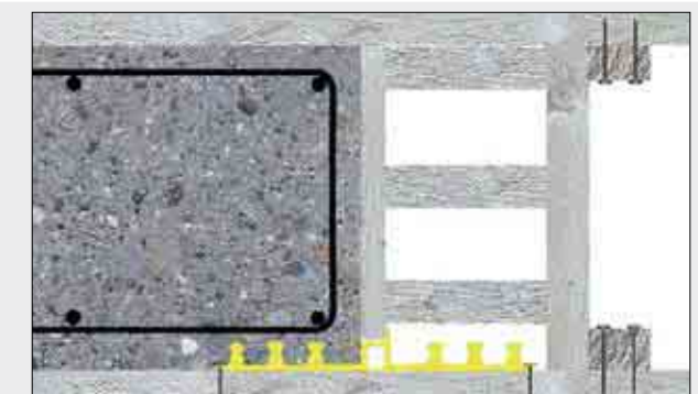
Uszczelnienie dylatacji - boczny szalunek oddzielający przy taśmie powierzchniowej
