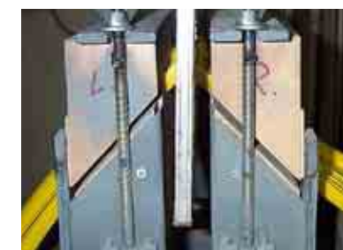
Nadtopienie mieczem do zgrzewania
