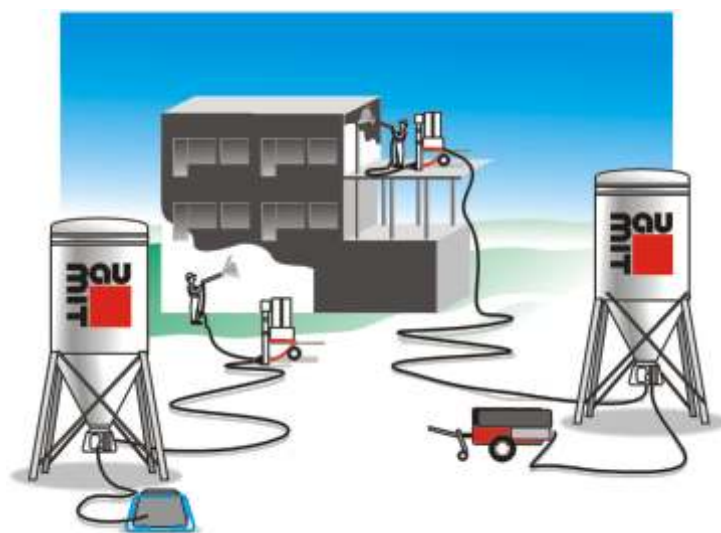
Silos bezciśnieniowy + podajnik pneumatyczny + agregat tynkarski.
