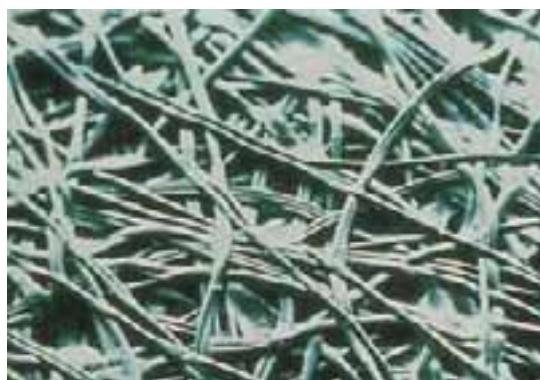
Rys. 2: Typar® - obraz pod mikroskopem
