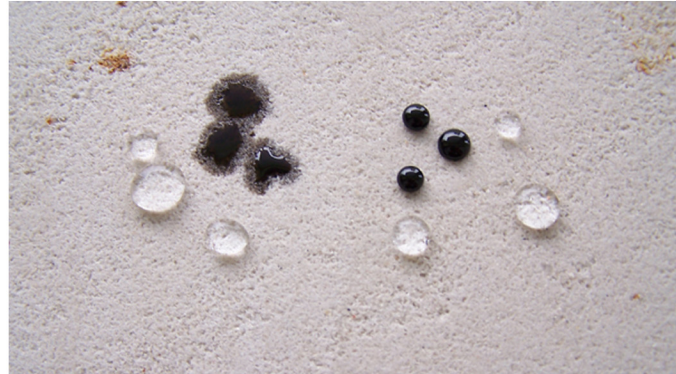
Powierzchnia hydrofobowa blokowane jest wyłącznie wsiąkanie wody.
