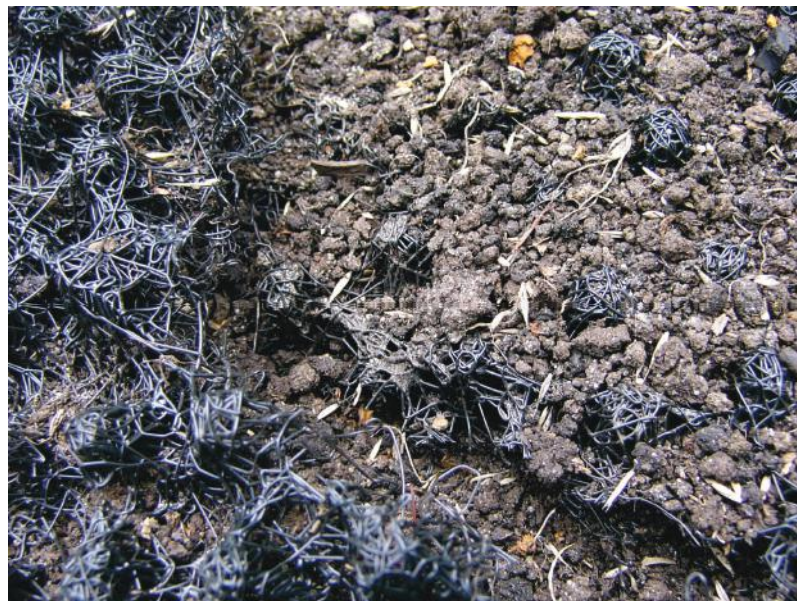
Rys. 87. Rozerwana geomata na poltku nr 9 (12 sierpnia) (Fot. B. Gajewska)
