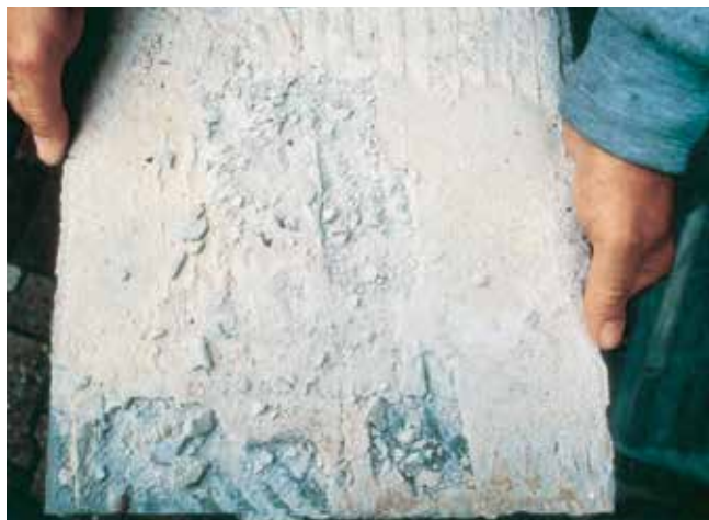
Utrata przyczepności spowodowana utworzeniem się etryngitu.
