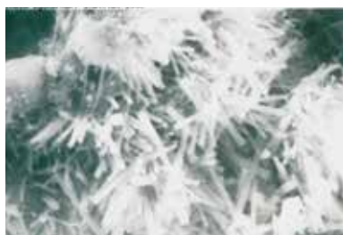
Tworzenie się etryngitu w tradycyjnej zaprawie cienkowarstwowej w strefie zetknięcia się z jastrychem anhydrytowym (na bazie siarczanu wapnia).
