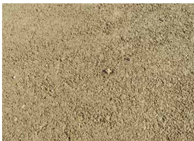
4 Związana konstrukcja z jastrychu drenażowego, o otwartej, wodoprzepuszczalnej strukturze.
