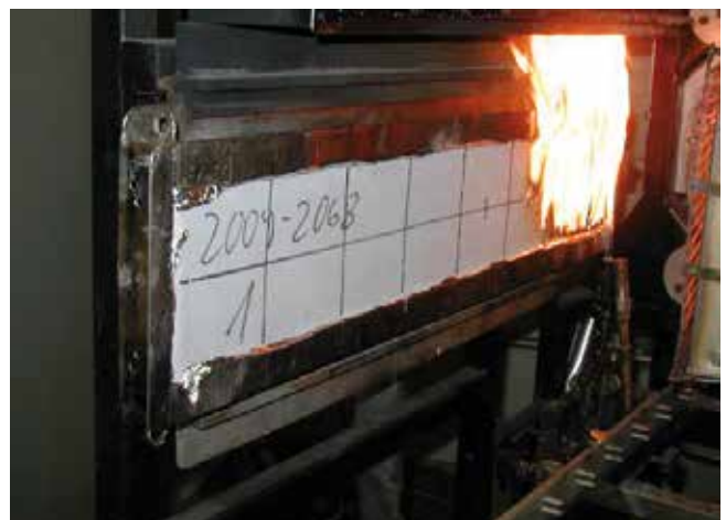
Test pożarowy materiału.
