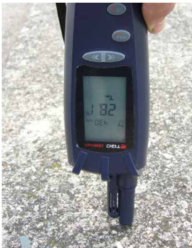
Pomiar temperatury elementu konstrukcyjnego.
