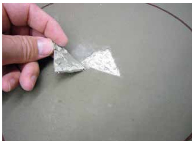
Wycinek uszczelnienia do określenia grubości warstwy.
