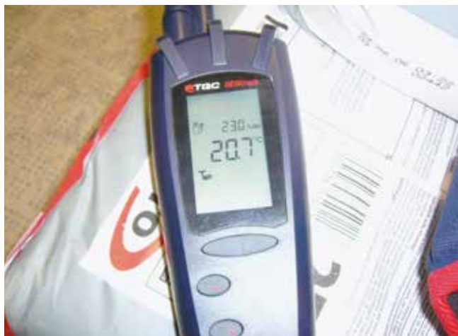
Pomiar temperatury powietrza i wilgotności względnej.
