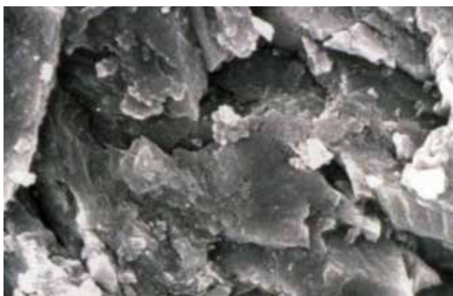
Zdjęcie mikroskopem elektronowym: duże pory świadczą o tym, że kamień naturalny ma tendencję do absorbowania wody.
