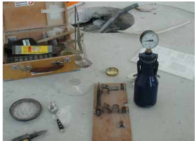
Pomiar wilgotności resztkowej aparatem CM. Próbę pobiera się z całego przekroju jastrychu.
