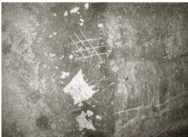
Ocena nośności powierzchni poprzez wykonanie testu na zarysowanie.
