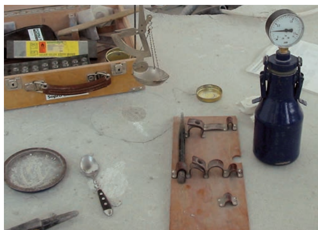
Oznaczenie wilgotności jastrychu przy pomocy urządzenia CM.
