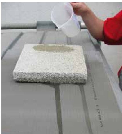
Wysoka wodoprzepuszczalność zaprawy drenażowej Sopro DM 610
