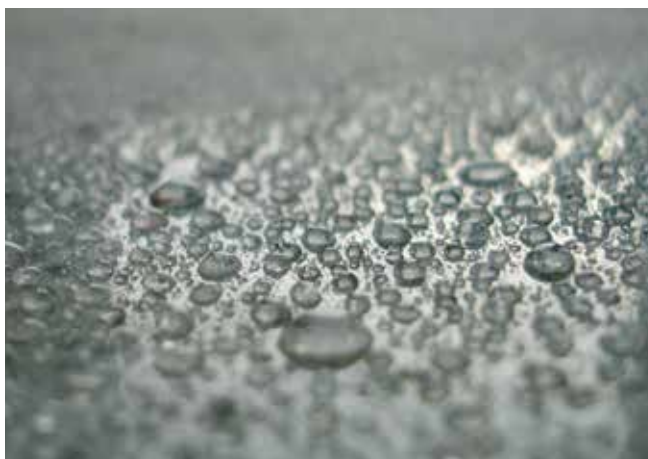
Powierzchnia zabezpieczona impregnatem.
