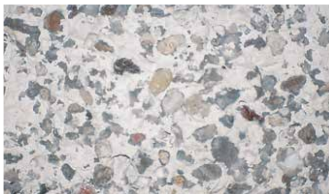
Spójna struktura po zastosowaniu zaprawy iniekcyjnej do wypełniania pustek pod płytkami Soprodur® 900 .
