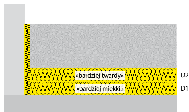
Jeżeli tworzy się kombinacje izolacji termicznej i akustycznej, na górze musi znajdować się materiał „twardszy”.
