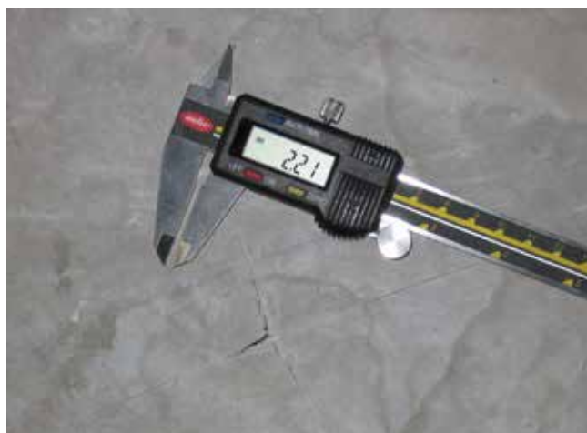
Suwmiarka do pomiaru grubości warstwy uszczelnienia.
