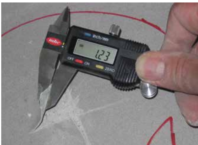
9 Kontrola łącznej grubości uszczelnienia zespolonego.
