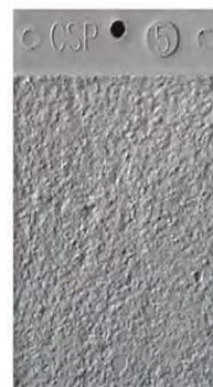
CSP-5: Średnie śrutowanie/ młotkowanie
