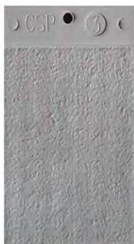
CSP-3: Delikatne śrutowanie/ młotkowanie
