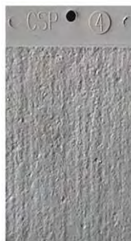
CSP-4: Delikatne/średnie śrutowanie/delikatne frezowanie/młotkowanie
