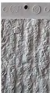
CSP-9: Głębokie frezowanie
