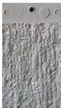
CSP-6: Średnie frezowanie
