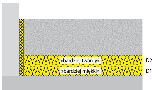
Jeżeli tworzy się kombinacje izolacji termicznej i akustycznej, na górze musi znajdować się materiał „twardszy”.
