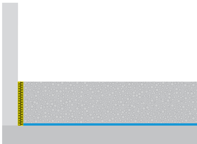
Jastrych zespolony: bezpośredni styk z podłożem poprzez mostek szepny.
