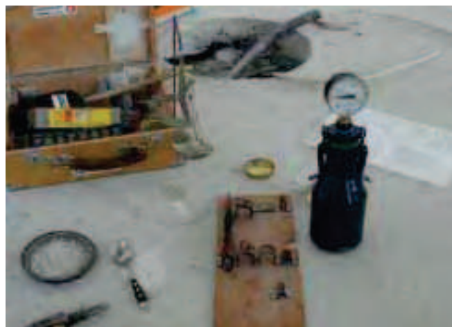
Pomiar wilgotności resztkowej aparatem CM. Próbkę pobiera się z całego przekroju jastrychu.
