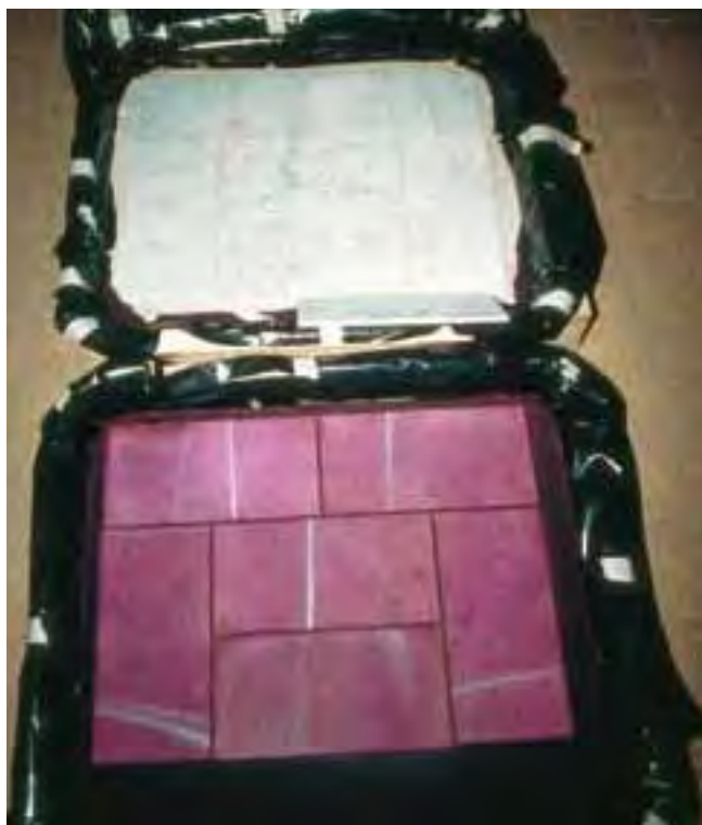
Dla porównania – całkowity brak przebarwień przy zastosowaniu zaprawy uszczelniającej do marmuru Sopro (powierzchnia górna na zdjęciu).
