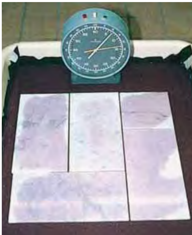
Bez zabezpieczenia – szybkie powstawanie przebarwień
