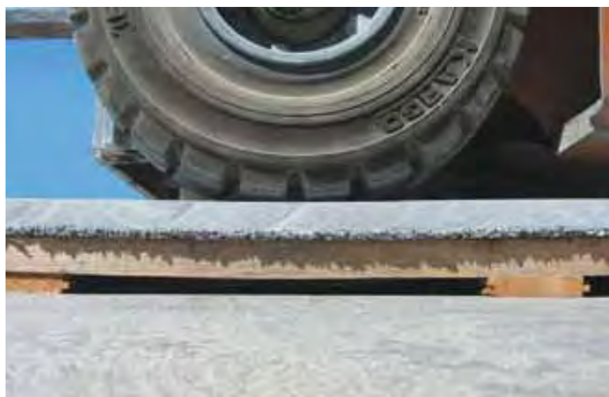
Szpachla epoksydowa Sopro o grubości 2 cm na podłożu odkształcalnym, pod dużym obciążeniem (wózek widłowy)
