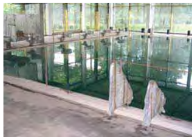
10 Próba wodna (minimum 14 dni).
