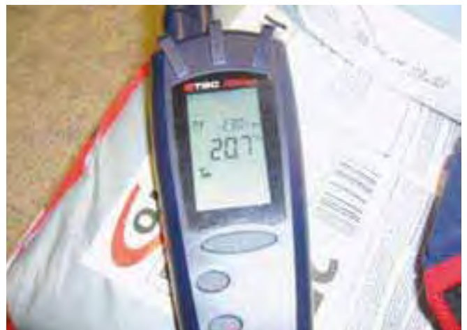
Pomiar temperatury powietrza i wilgotności względnej.
