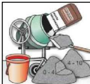
W betoniarce należy wymieszać spoiwo zmodyfikowane polimerami MAXMORTER FLOOR z kruszywem 0+4 mm oraz żwirem 4+10 mm, a następnie dodać wody. Zużycie w ciągu 30 min.
