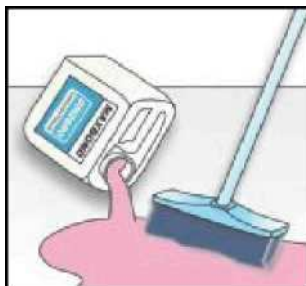
Preparat gruntujący należy rozprowadzić za pomocą szczotki.
