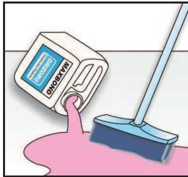
Preparat gruntujący należy rozprowadzić za pomocą szczotki.
