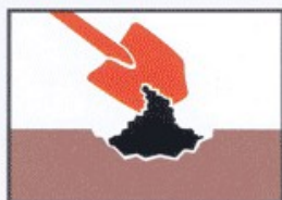
Wypełnieniu masą IRR i wyrównaniu łopatą
