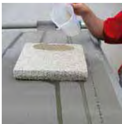
Duża wodoprzepuszczalność w próbce jastrychu drenażowego
