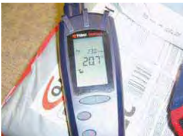
Pomiar temperatury powietrza i wilgotności względnej.
